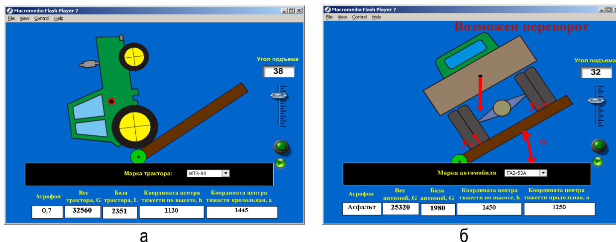
Рис. 5. Вивчення поздовжньої та поперечної стійкості трактора та автомобіля
