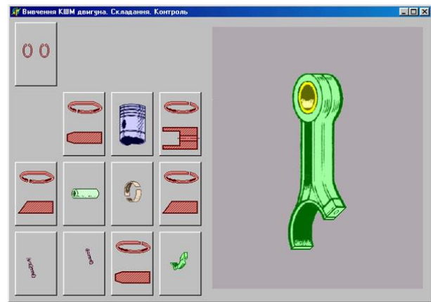
Рис. 1. Вивчення процесу складання кривошипно-шатунного механізму
